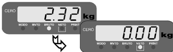
Coloque sobre la plataforma el recipiente a destarar. Pulse
