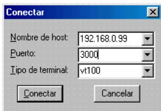
Ingrese al menu Conectar / Sistema remoto... y coloque en “Nombre del host” el IP del indicador (192.168.0.99) y en “Puerto” el valor del puerto (3000).
