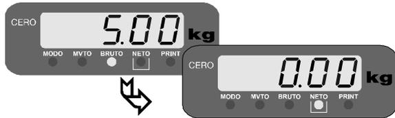
Coloque el peso patrón sobre la balanza y presione la tecla
